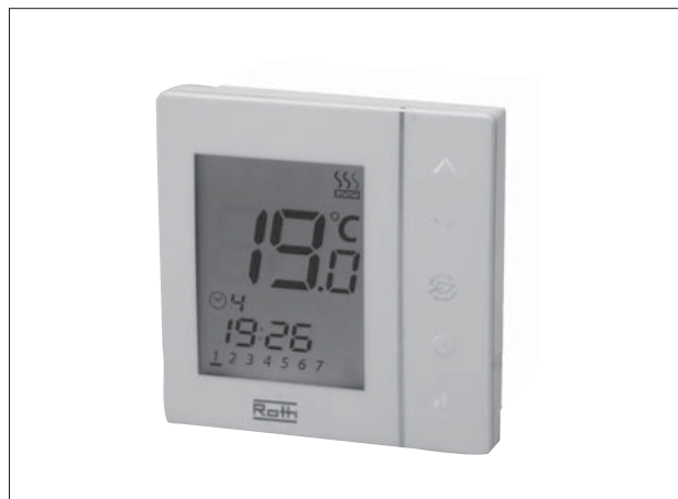
Termostat zegarowy Basicline T max 5 siłowników do 1 termostatu wymagany przewód 4 - żyłowy o przekroju żył 1 mm 2
