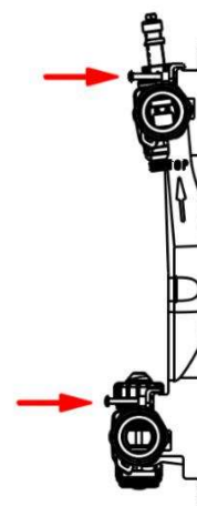
4. Załączoną śrubą zamocuj zamknięty wspornik
