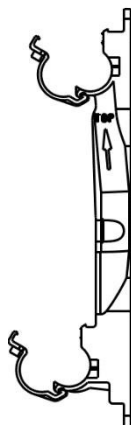
2. Włóż belki rozdzielacza w uchwyty i wyrównaj na uszczelnieniu
